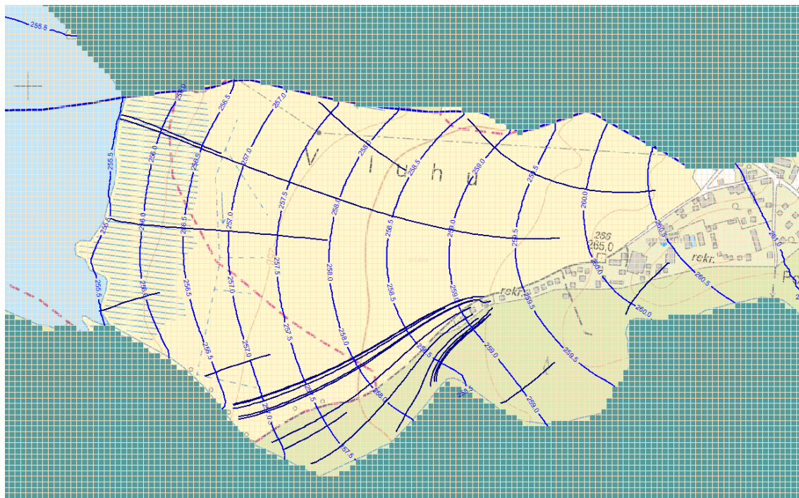
OBR.9b Modelové proudové pole podzemní vody - varianta 1 povolené zasakování
